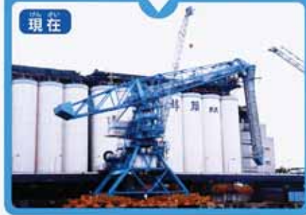
機械式アンローダ(穀物を船からあげる機械)
